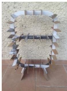
Le montage s'appuie sur des traverses, morceaux de carton composés d'encoches que l'on emboîte sur les profils intermédiaires. Les traverses soutiennent la structure du meuble, leur longueur dépendant de la profondeur que vous voulez obtenir.
