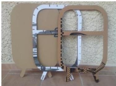
La première étape consiste à dessiner et découper les profils qui composent la structure du meuble, à savoir la façade, le fond et les profils intermédiaires. Une fois les profils réalisés, on découpe les niches.
